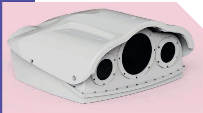
В середине располагается тепловизионная камера, справа камера с узким полем обзора, слева — с широким
